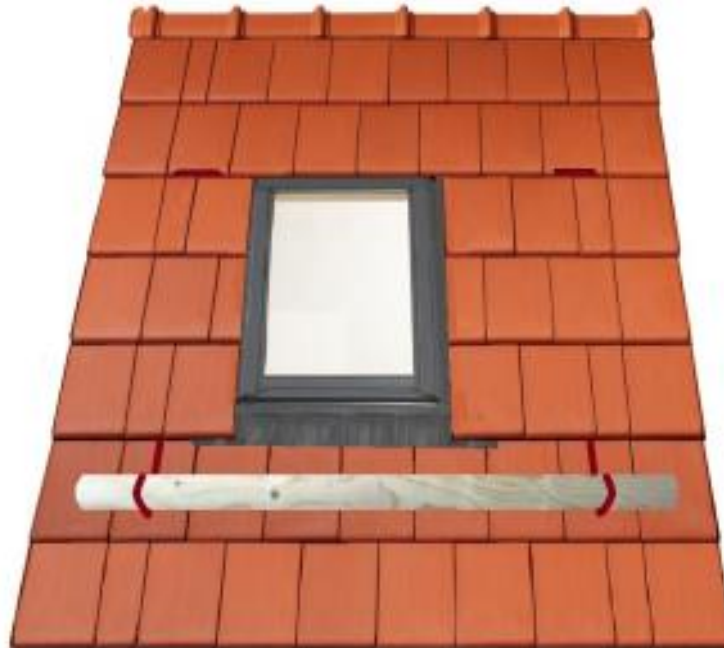
Obr. 2 - NENÍ NUTNÉ PŘESNÉ VYSTŘEDĚNÍ OKNA V PLOŠE
